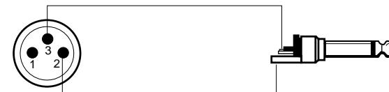
E-Gitarren und E-Bässe benötigen ein spezielles Kabel, bei dem Pin 1 unbedingt frei bleiben muß. Dieses Kabel ist als Zubehör (**DSGK**) lieferbar.
